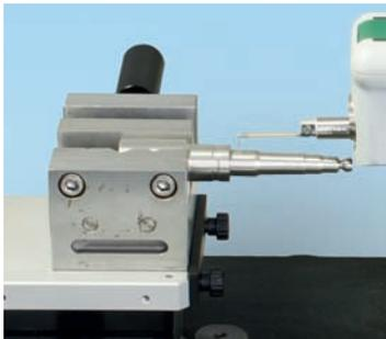
**Messung einer abgestuften Welle**
