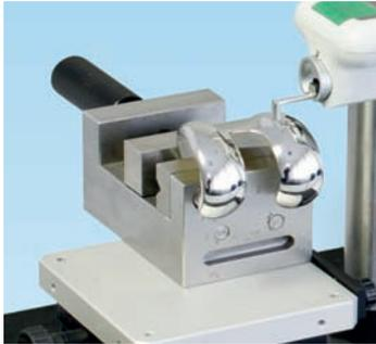
**Messung eines Kniegelenkes**
